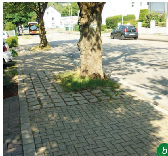
Abbildung 27: Baumpflanzungen im Gehwegbereich der Blücherstraße. Die Bäume sorgen durch Beschattung für Abkühlung und dadurch für ein angenehmes Klima, ihre Lage schmälert die Durchgangsbreiten jedoch wesentlich. a) Schäden durch Wurzeln wurden unter einer teilweisen Entsiegelung saniert. Die offene Baumscheibe wird hierdurch jedoch trittverdichtet. b) Durch die Anhebung der Wegebeläge infolge der Entwicklung oberflächennaher Wurzeln wird die Nutzbarkeit des Baumumfeldes zudem allmählich eingeschränkt.
